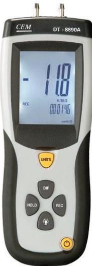
Este dispositivo mide la calibración de presión diferencial, cuenta con 11 unidades de medida seleccionables: inH<sub>2</sub>O, psi, bar, mbar, kPa, inHg, mmHg, Ozin, ftH<sub>2</sub>O, cmH<sub>2</sub>O, kgcm. Las características adicionales incluyen retención de datos, apagado automático desactivado, y USB para la captura de datos en un PC utilizando el software opcional. El uso de este medidor le proveerá muchos años de servicio confiable.
