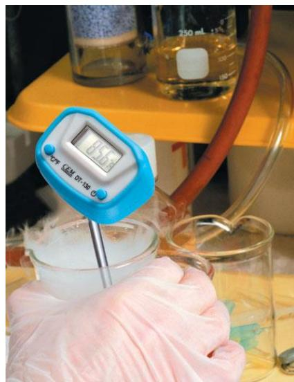
Termómetros de contacto DT-130 ofrecen una respuesta rápida y una precisión de laboratorio. Estos termómetros ofrecen 0.1 °C/0.1 °F de resolución sobre la totalidad de los rangos de medición. Una funda robusta protege el modelo
