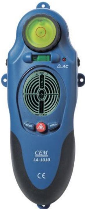
LA-1010 emplea una señal electrónica por la pared para localizar el metal, madera y alambre, una vez el objeto es descubierto, el equipo emite un sonido y la pantalla LCD muestra la posición.
